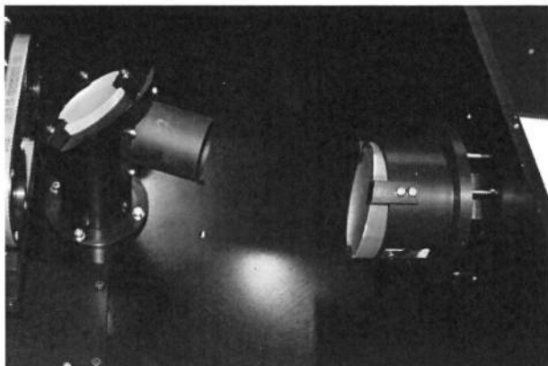
Bild 8: Den paraboliska spegeln till höger samt planspegeln till vänster. foto L. Karlsson.
