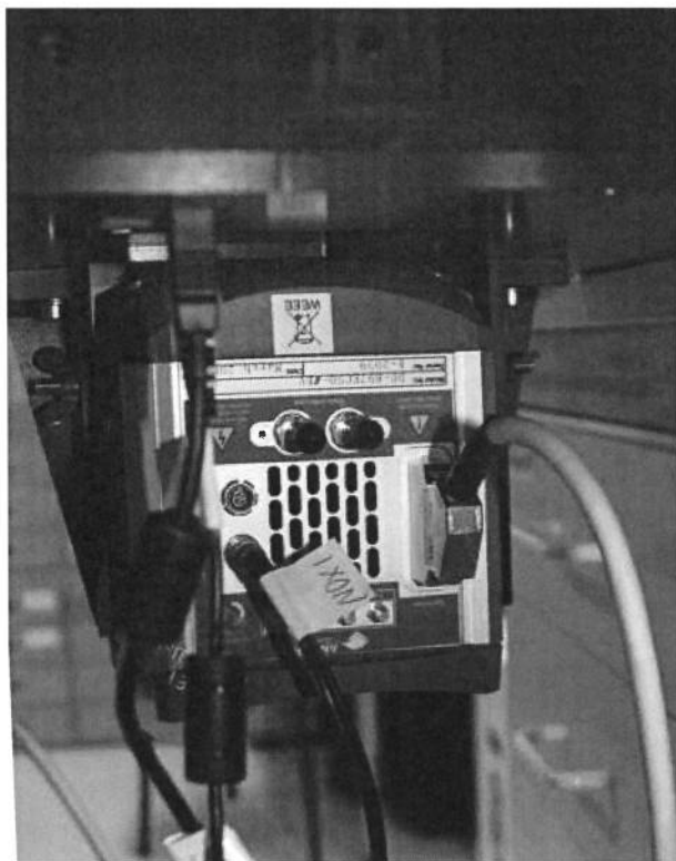
Bild 9: Kamerans syns här monterad i botten av apparatenheten. Ovanför ventilationshålen syns vattenanslutningen för kylningen.
