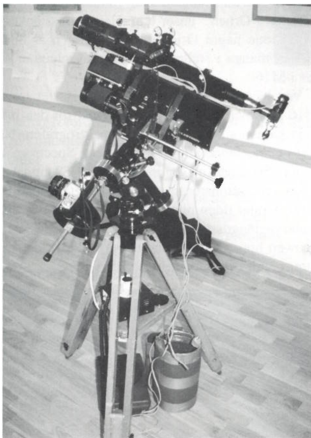
Celestron's "Kometfångare". Ett 5,5" Schmidt Newton system med f/3,64 optik. Systemet har också en 2,4" refraktorledtub och diverse kameror monterade på ett Unitron ekvatorialstativ.
