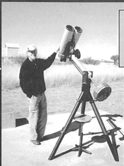
Gunnar med Fujinon-kikaren 25x150 mm. Synfält 2,7 grader. Fantastiskt fint att skanna Vintergatan med.
