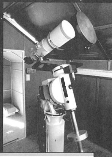
Reflektor Celestron C11 och refraktor Takahashi FSQ106 på en Astro-Physics GTO1200 montering. De populäraste instrumenten för foto.
