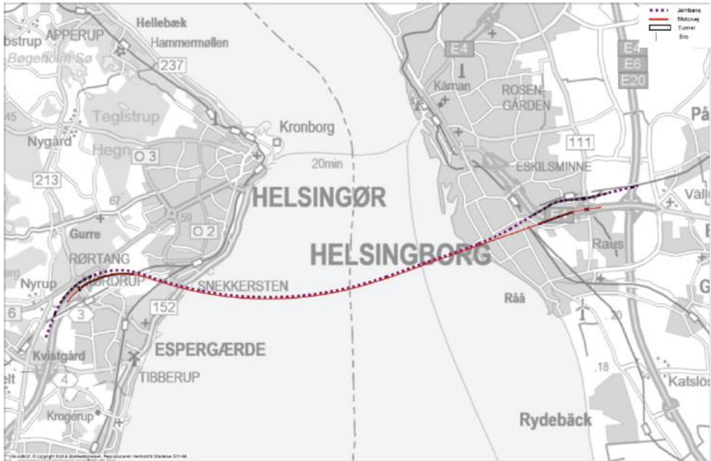
Figur 14. Visar skisserad linjeföring av väg- och bantunnlar samt förslag till anslutningar till existerande infrastruktur på landsidorna.
