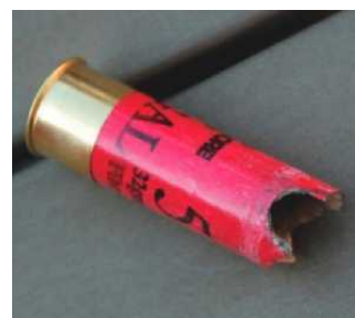
Så här ska det absolut inte se ut. Men fenomenet är inte ovanligt med 65 mm patroner i ett 76 mm patronläge. Både fart och träffbilder påverkas.
