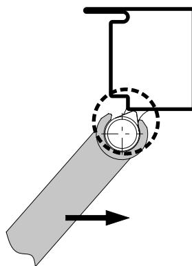
5. Ajustez de la paumelle partie inférieure soudé au cadre. Faites attention à l'utilisation correcte conformément au marquage sur l'outil de centrage des paumelles pour le type de paumelle respectif («Anschweissband» pour paumelles à souder et paumelles à visser, «Rollentürband» pour paumelles à galet). La correction souhaitée peut être obtenu en poussant ou en tirant doucement.
