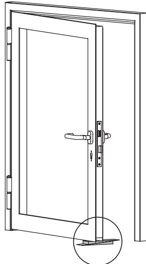
3. Ouvrez la porte d'environ 10-20° et soulager la paumelle supérieure de la porte par exemple en plaçant des cales en bois sous le vantail de porte.
