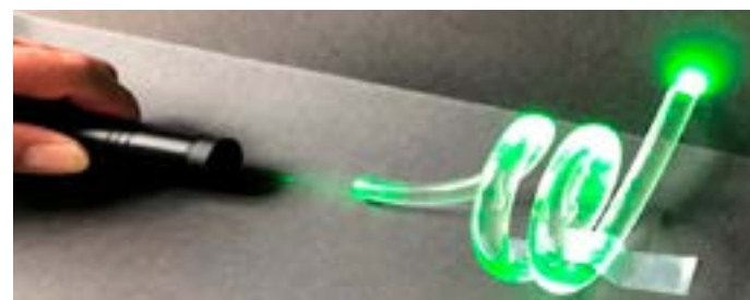
Figur 5: Laserlyset bevæger sig igennem glasspiralen, stort set uden at bryde ud
