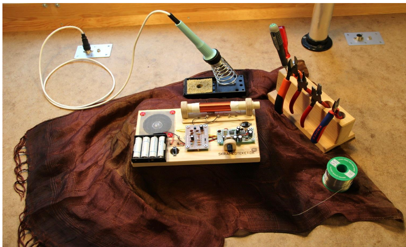
Skramlotekets radiomodtager anno 2015. Det er en langbølgemodtager, men nu også med en omskifter til mellembølger !
