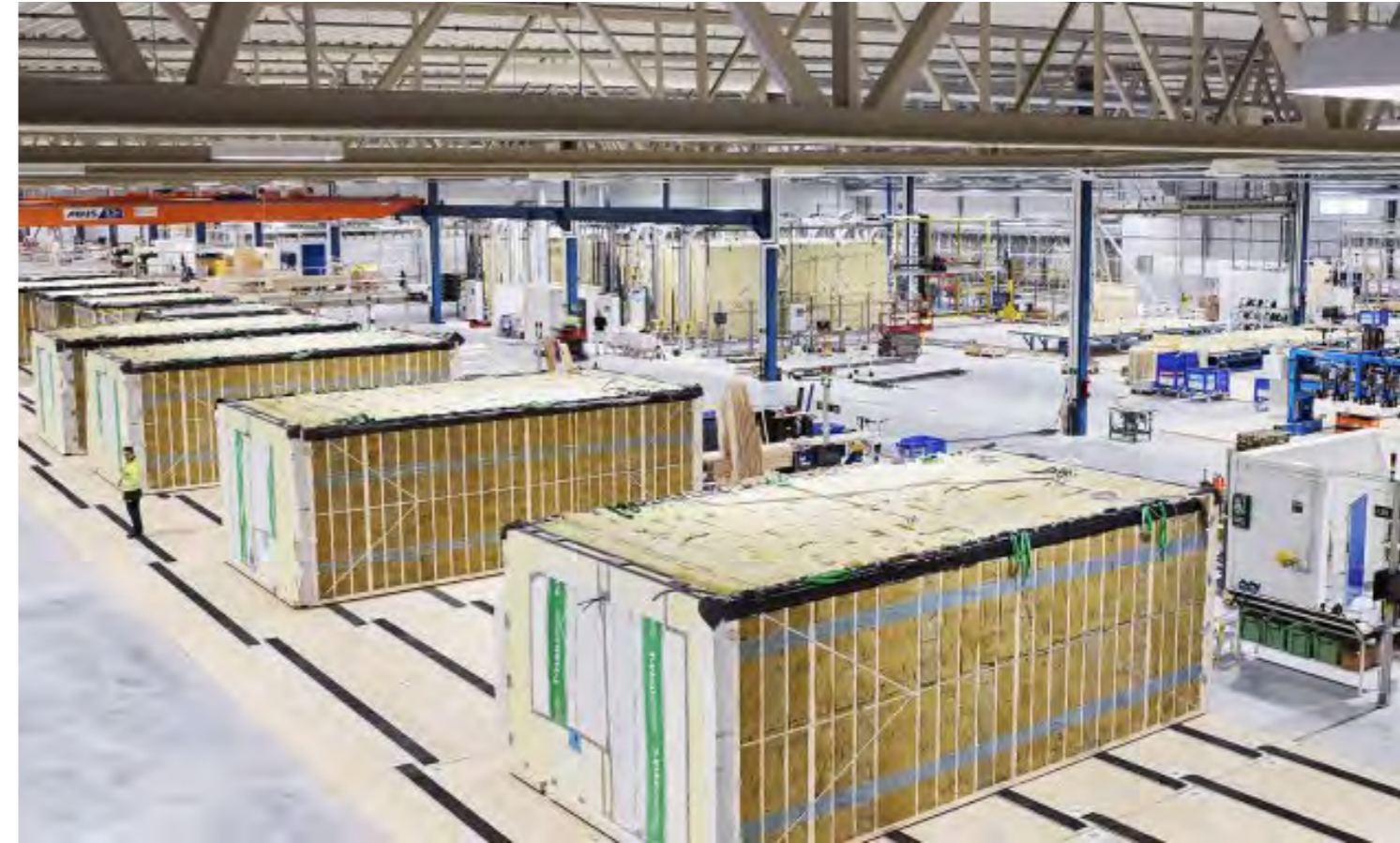
Volymelement i trä under produktion
