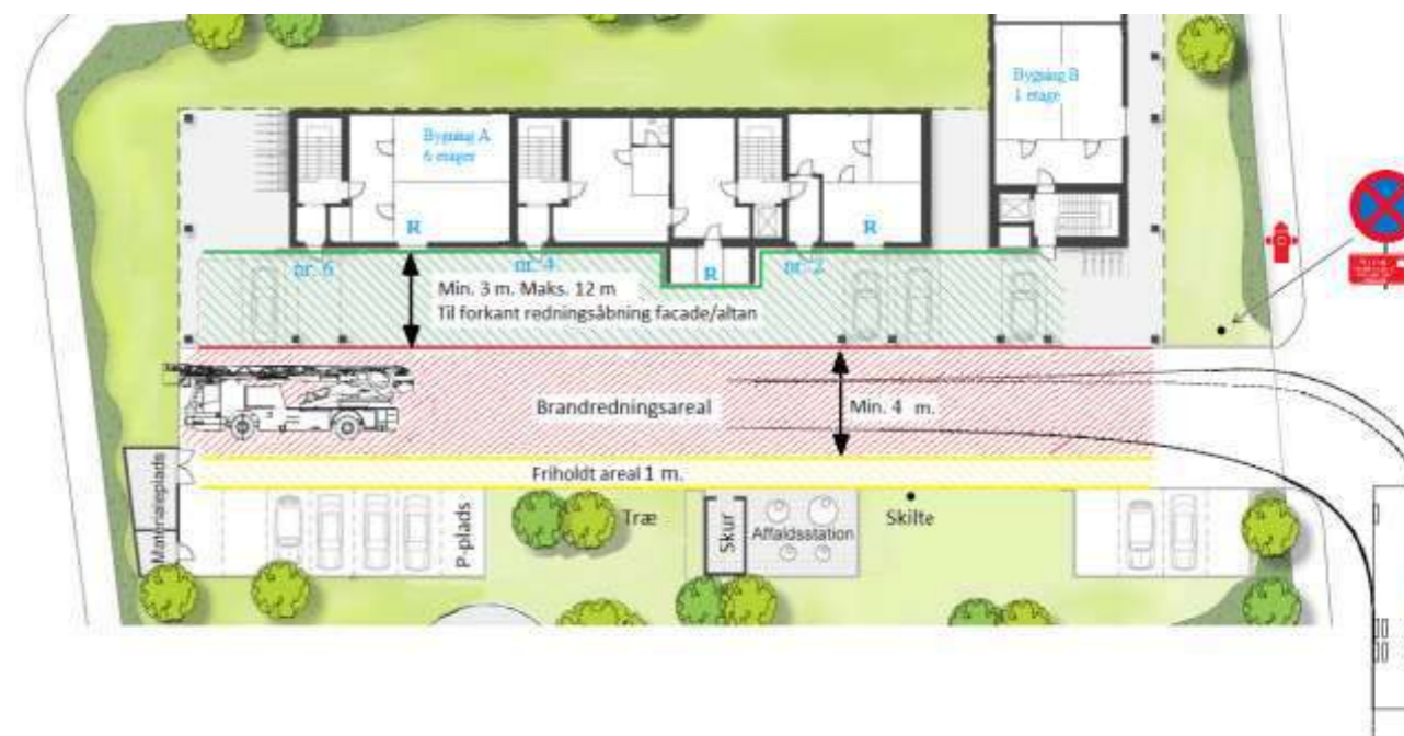
Figur 3 viser situationsplan med pladskrav til brandredningsarealer for drejestige, og med angivelse af husnummereringen, antallet af etager, redningsåbninger, bredder og drejeradier, placering af brandhaner samt indretning af omgivelser, herunder nabobygninger
