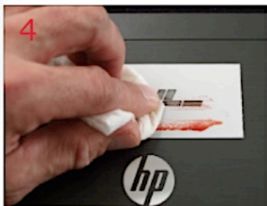
4 Efter 5-6 minutter fjernes overskydende pasta med en fugtig klud. Undgå at pastaen kommer uden for skabelonen!
