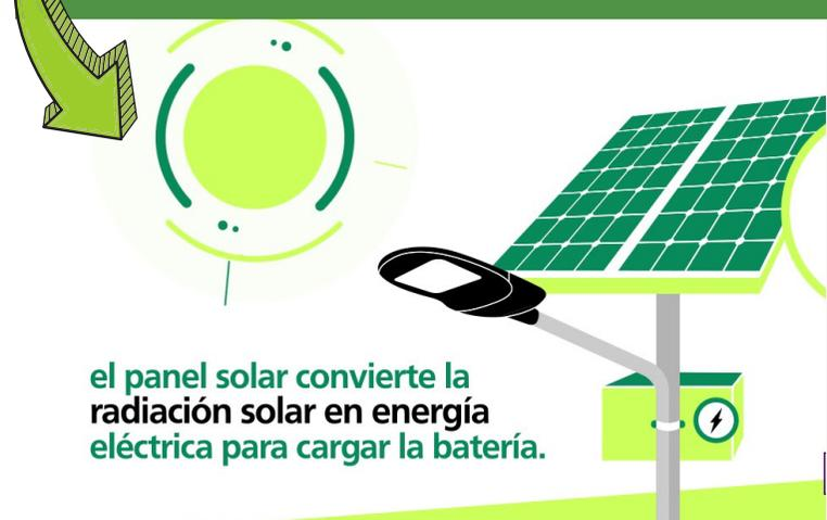
el panel solar convierte la radiación solar en energía eléctrica para cargar la batería.
