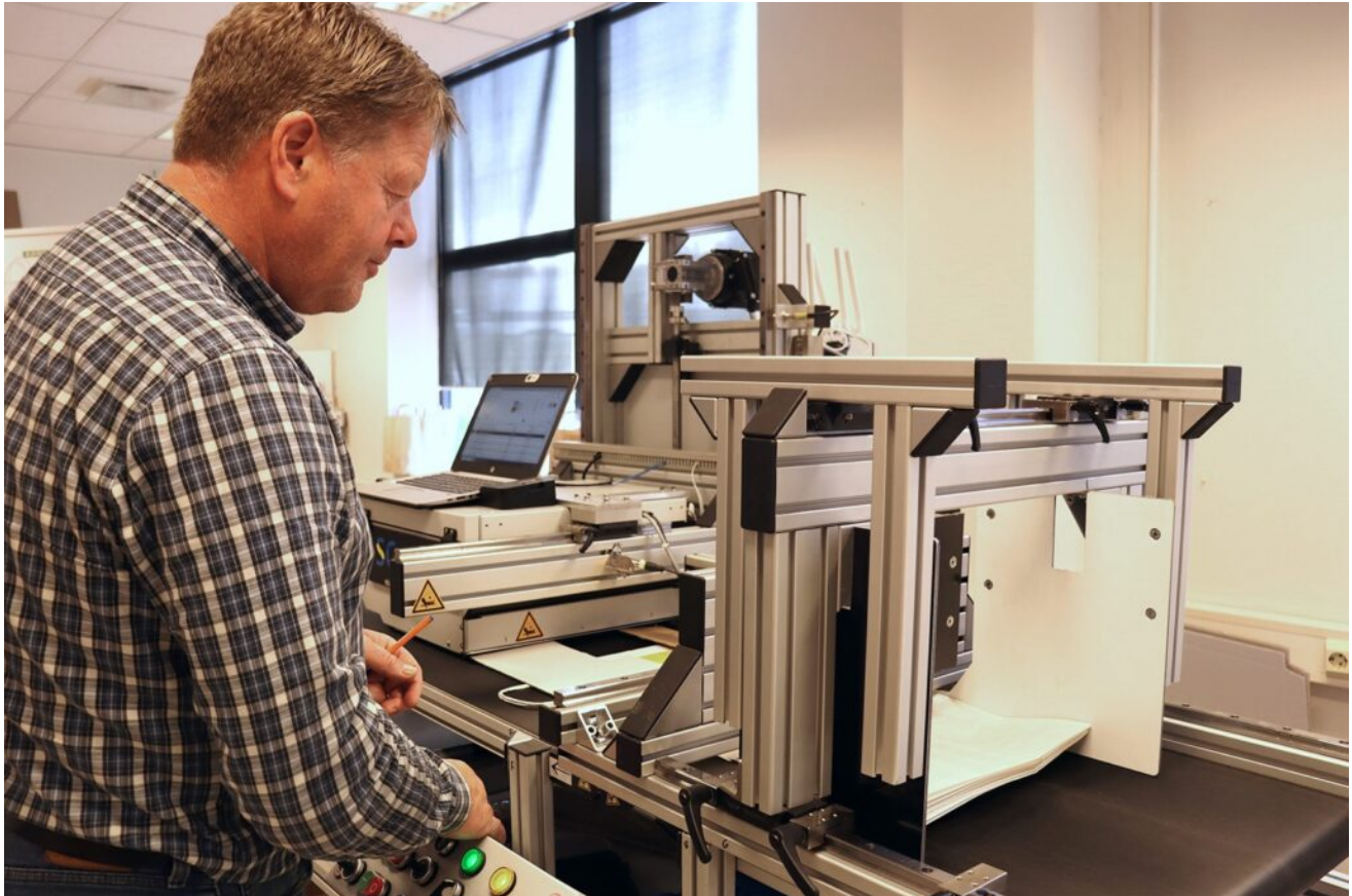
Skrivaren skriver ut med CMYK på en mängd olika medier. Trond Bu visar hur man laddar maskinen.
