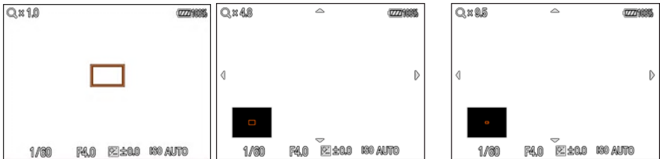
Fokusforstørrelse] visning på \alpha 55 . Området i den orange ramme er forstørret. Vælg 4,8x eller 9,5x forstørrelse.
