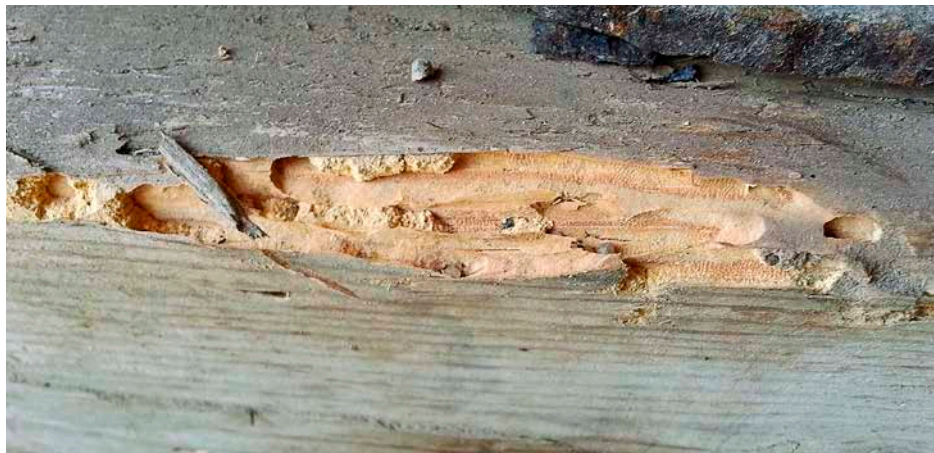
Husbockslarven knaprar under många år slingrande gånger inne i splintveden. Till höger i bilden finns ett ovalt kläckhål. Foto: Thomas Persson Vinnersten.
