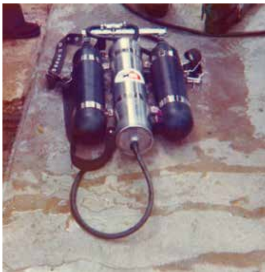
Den apparat för helioxdykning till stora djup, utvecklad av Comex, som användes vid dykförsöket. Mellan behållarna sitter en elektrisk gasvärmare för att motverka heliumets nedkylande effekt.
