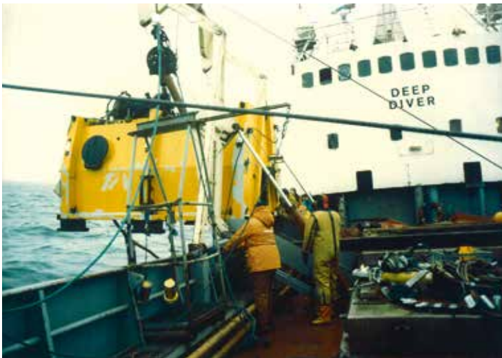
Sjösättning av habitatet i Öresund. Uno Jacobsson kör hydrauliken till lyfttramen, medan Jan Jacobsson står standby i torrdräkt för att gå ner och sätta habitatet på plats. Foto: Douglas Samuelsson.
