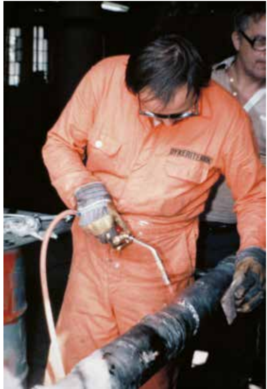
Jan Jacobsson övar på smetlödning i GDA:s verkstad. I bakgrunden syns en av våra instruktörer från ASEA Kabel. Foto: Douglas Samuelsson.
