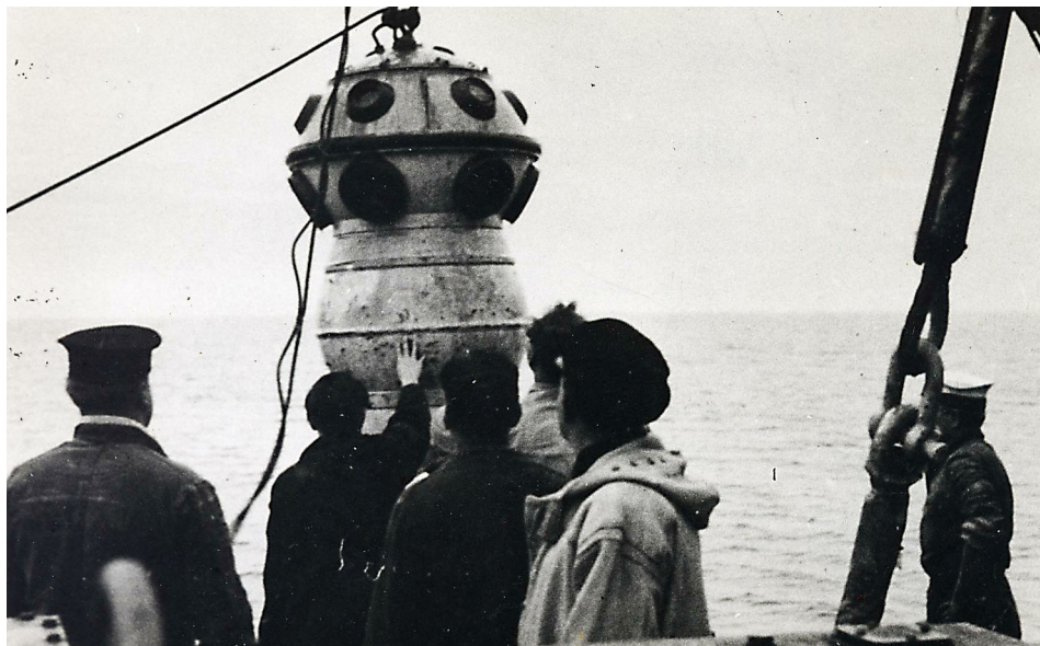
Observationskammeret som blev anvendt ved dykningen til 1060 fod. (George Wookeys samling)
