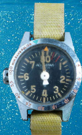
Schweiziske Aquastar dybdemåler fra ca. 1960 med 0-deko eksponeringskrans.
