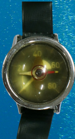
Tysk dybdemåler med integreret kompas. Doneret af Knud-Helge Andreassen, Nykøbing F.
