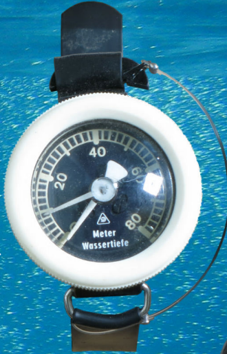
Dybdemåler fra Drägerwerk ca. 1959 med skæbeviser, der kan 0-stilles med den lille magnet, der sidder i remmen. Doneret af Søren Olsen, Svendborg.
