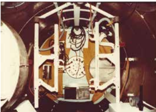
Inne i sveisekammeret i det hyperbare systemet i Great Yarmouth.
