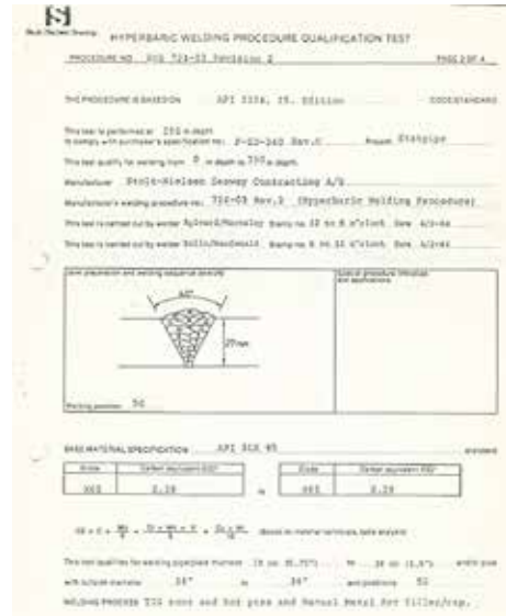
Hyperbar sveisekvalifikasjonsprosedyre for NUTEC-dykket i 1984.
