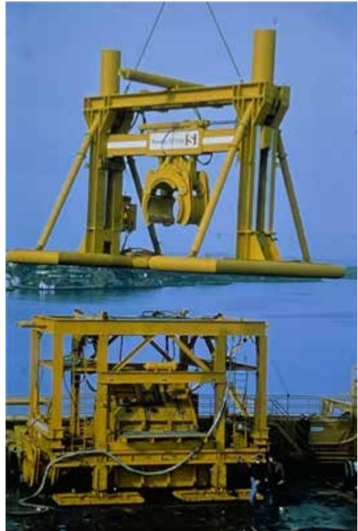
Seaway sveisehabitat og en av H-rammene under utprøving på Seaway Swan i 1979.
