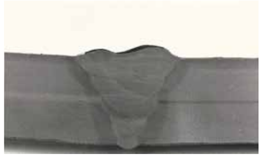
En makroseksjon fra en av Seaways hyperbare sveiser gjort i Great Yarmouth.
