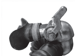
Bilde 37. Det gamle munnstykket til rebreatherne «Dräger Kleintauchgerät 138» og «Leutnant Lund I» ©Dräger Archiv. Foto HK
