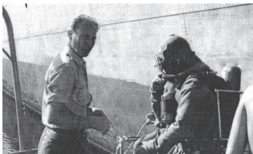
Bilde 45. Dykkeleder og signalmann Thorleif Thomassen og Dräger blandingsgassapparat «Leutnant Lund III» (Bilde fra et tidligere dykkforsøk). © Kilde: Bjørn Bjørnø
