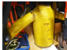
7-26-1 Docka för tillverkning av tungdykardräkter
