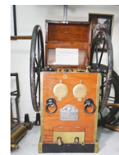
Luftpump för tungdykning
