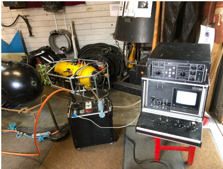
Cristine i sitt nya hem. Här har farkosten kopplats upp mot konsol och kraftaggregat för funktionstest. SDHF – 2018-07-18.
