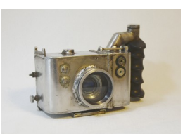
7-55-4 UV-kamerahus i rostfritt stål. Exp. RH
