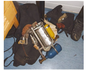
7-49-1 Räddningsapparat för ubåtspersonal
