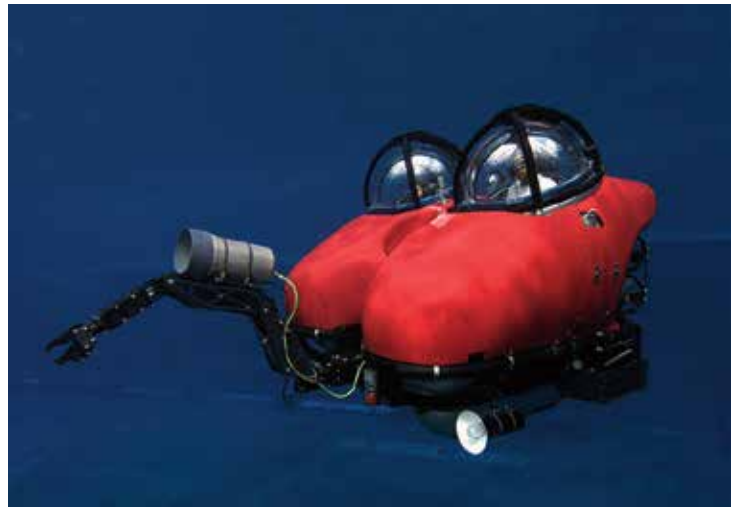
Tvåmansversionen, Dual DeepWorker, har ett största dykdjup av 600 meter. Foto: Nuytco Research Ltd.
