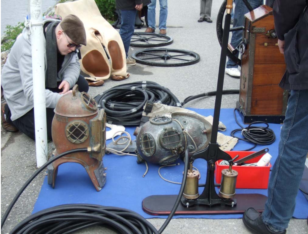
På kajen står en Miller-Dunn Divinhood Style 3 med sin spakpump och bakom denna ligger en dansk 2-bultshjälm med sin tillhörande 1-cylinder vevpump.
