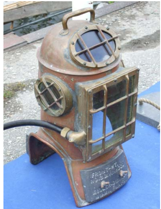
Miller-Dunn Divinhood Style 3 på väg upp ur vattnet. Hjälmen är öppen, vilket betyder att dykaren hela tiden måste hålla huvudet upprätt för att luften inte skall försvinna ur hjälmen.
