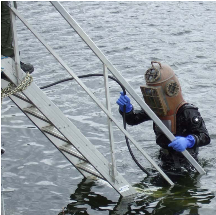
Miller-Dunn Divinhood Style 3 på väg upp ur vattnet. Hjälmen är öppen, vilket betyder att dykaren hela tiden måste hålla huvudet upprätt för att luften inte skall försvinna ur hjälmen.
