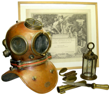
Charles Petits udstyr. 3-bolts hjelm, kniv, manchetudtrækker og elektrisk undervandslampe samt erindringsdiplom tildelt Charles Petit på verdensudstillingen i 1900.
