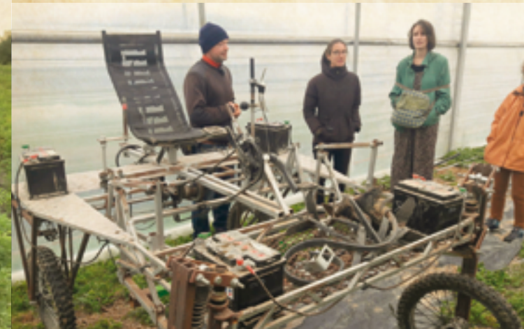
Aggrozouk: attrezzatura a pedale con assistenza elettrica, autocostruita da Boris Canal, coltivatore di ortaggi, con l'atelier Paysan. Visita di BAG in Francia, 2021.
