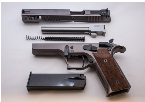
Pistol strippet for pussing. Delene er glidestykke, pipe, fjær og styrepinne, rammestykke med grep og avtrekk og magasin.
