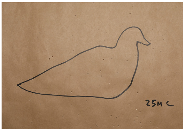
Hagleskudd avfyrt på 25 meter med Cylinder, som betyr ingen trangboring. Her sitter skuddene mer spredt, og det er færre treff i blinken.
