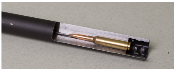
Patronen passer perfekt i kammeret i denne gjennomskårne rifle-pipa. Riflingen sees tydelig i løpet.
