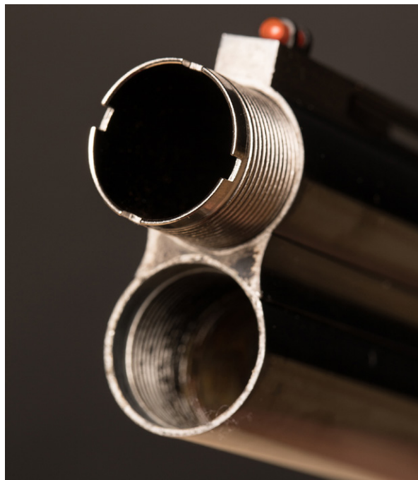
Trangboringer kommer i ulike varianter, og kan på mange våpen byttes ved at man skrur inn choker foran i løpet.
