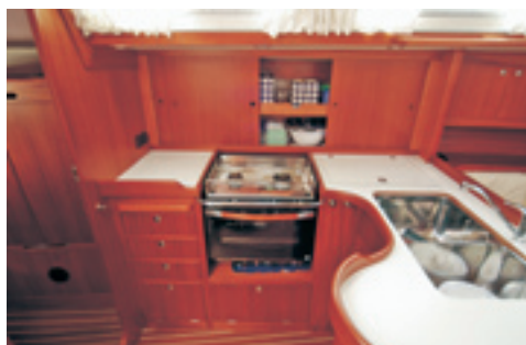
L-pantry med bue kan bruges til at stå fast under madlavning i sø.
