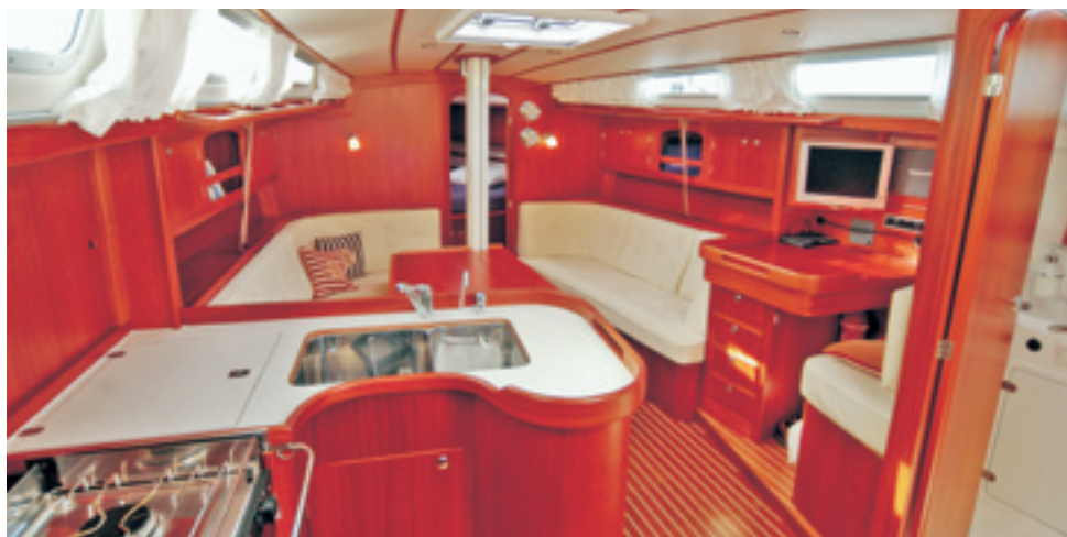
L-pantry med bue kan bruges til at stå fast under madlavning i sø.
