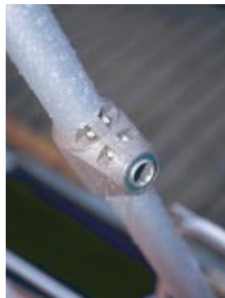
Häckstaget sträcks mekaniskt. Arrangemanget manövreras med ett vinschhandtag.
