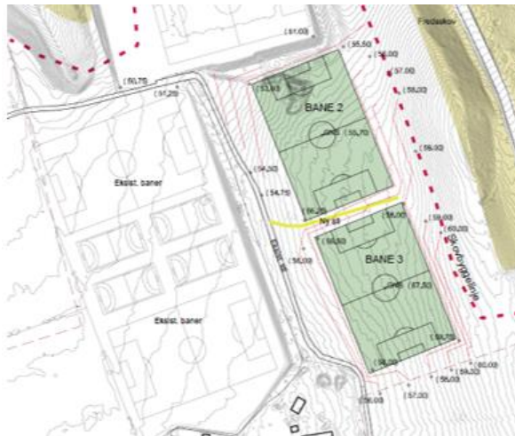
Figur 10 Etablering af 2 stk. erstatningsfodboldbaner på bakken
