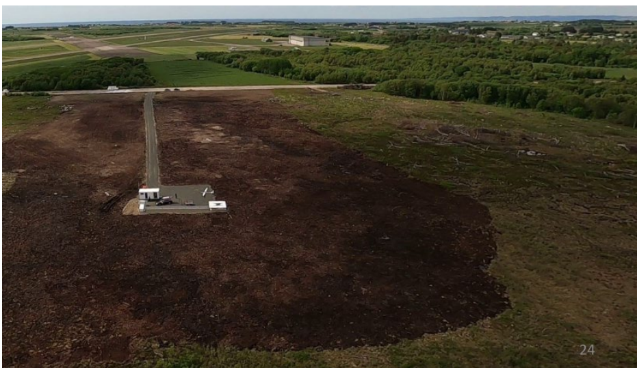
Figur 4-9 Kiteturbin på Hellemyra. Inngrepet består av bygging av vei og snuplass, samt fjerning av vegetasjon og røtter i et stort område rundt. Kilde: Kitemill.
