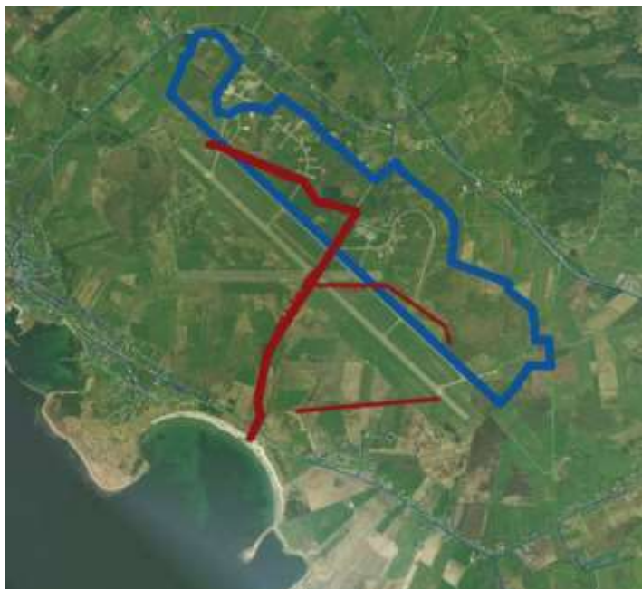
Figur 26 Planområdets avgrensning er vist med blå strek. Eksisterende VA-ledningsnett vises i bakgrunnen. De tykke, røde strekene viser omtrentlig plassering av lukkede kanaler på området lukkede kanaler i området, basert på gammelt kartgrunnlag. Kartgrunnlag: Googlemaps.no.
