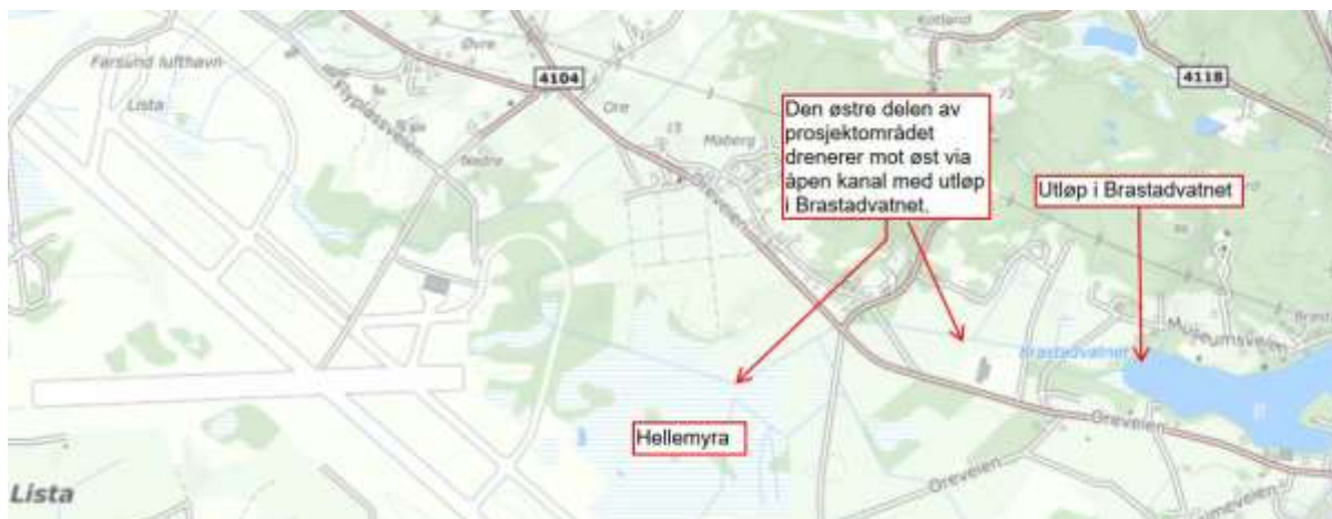
Figur 40: Den østre delen av prosjektområdet drenerer mot øst via åpen kanal med utløp i Brastadvatnet.
