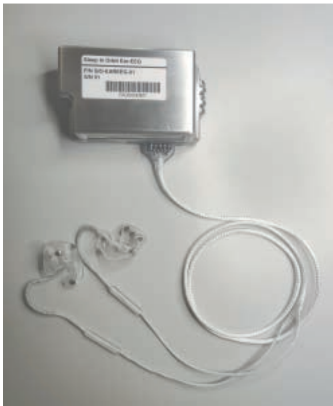
Figur 2. (til venstre) Måleelektronikken med ørepropper og elektroder.
