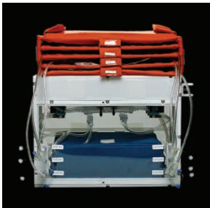
Figur 3: Fronten af groundmodel af Aquamembrane 3-testopstillingen. Spildevandsposer bliver sat ind i den orange holder og tilsluttet systemet. Den osmotiske trækopløsning sidder i poserne i den blå holder. Aquaporin membraner sidder i loftet på indersiden af kassen. Foto: Aquaporin
