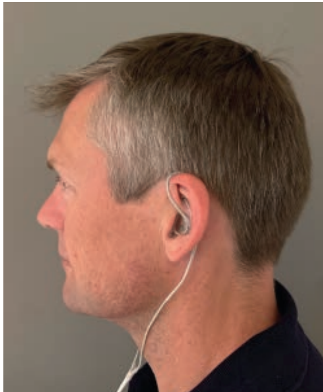
Figur 2. (til venstre) Måleelektronikken med ørepropper og elektroder.
