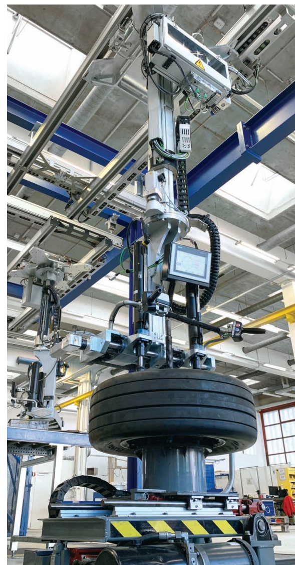
Die AUA-Werft in Schwechat: Die neue, vom steirischen Ingenieurbüro Roxa Technologies entwickelte Anlage erleichtert die Montage von Flugzeugreifen.
