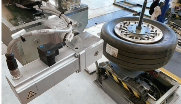
Ein Schrittmotor »EMMS« bewegt am unteren Ende des Werkzeugkopfs zwei spiel-freie Schlitten, die den Abstand der beiden Schrauber zueinander verändern.
