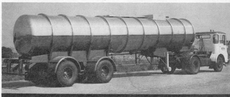
Fig. 6. Tankvagn i rostfritt stål, byggd i lättviktskonstruktion; tomvikt 5,1 t, lastförmåga 24,6 m 3 .
