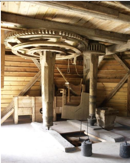
Gangtøj i ”Mademose mølle” og sådan som det vil komme til at se ud i Ulstrup Mølle
