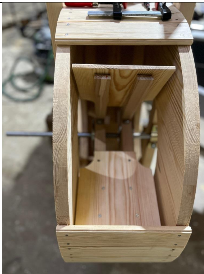
Indbygning af blæserhjulet
