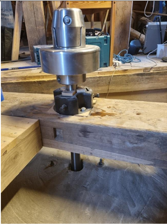
Medløbsskralden fra HRS stål monteret
