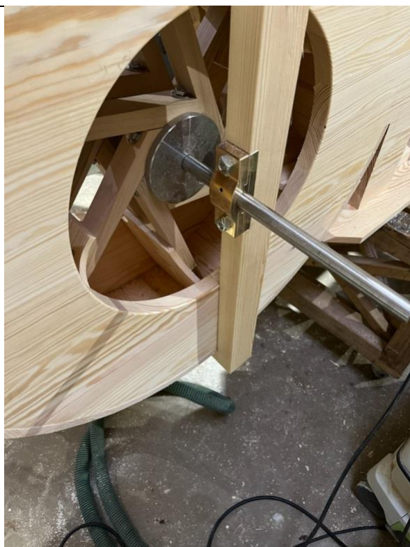
Gangtøjet med blæserhjul på plads
