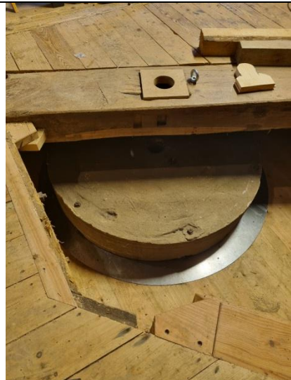
Kværnstenen på plads i grubben
