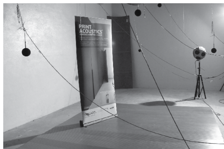
Labo testopstelling - EN ISO 354:2003
