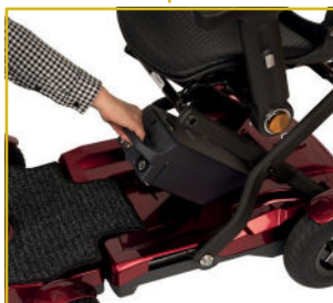
Bateria de lítio amovível (14,5 Ah) para um carregamento fácil
