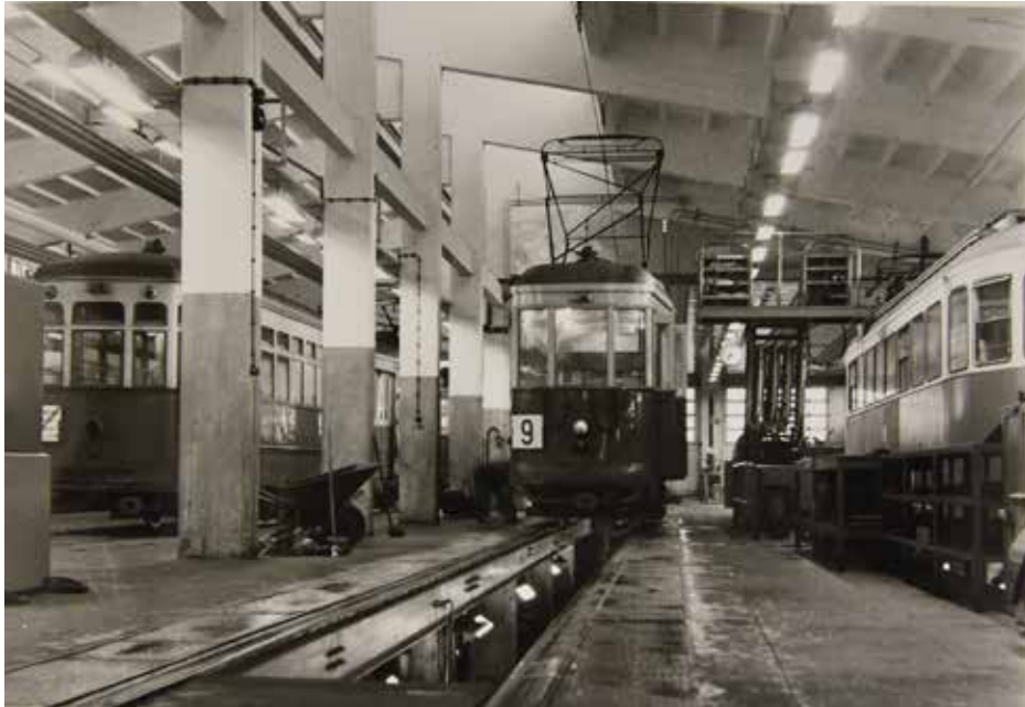
Raitiovaunujen huoltohallissa keskellä oleva raitiovaunu on alustan tarkastuspai- kalla. Foto Okkola, 20.10.1956, HKM, reprokuva Sanna Ihatsu.
