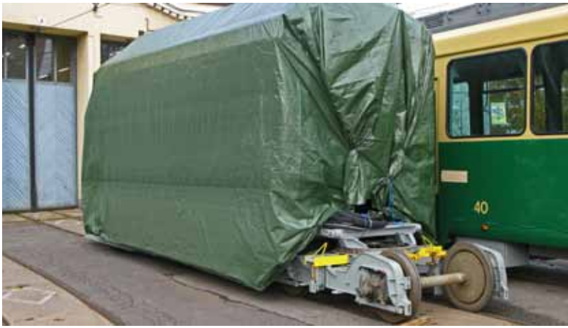
Siirtoteleillä kulkeva irtovälipala odottaa suojahupun alla asennusta. Hupun alta pilkistää melkoinen kaapelipaketti, joka aikanaan liitetään A-vaunuun. Kuva Arto Hellman 28.10.2009.
