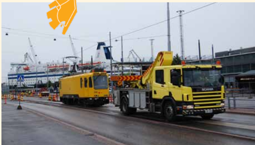
Ensimmäinen raitiovaunu eli työvaunu 2010 uudisradalla 23.7.2012. Vaunun edellä ajoi torniauto seuraamassa virroittimen kulkua ajolangalla. Taustalla näkyy vuonna 1981 rakennettu entinen Silja Linen M/S Finlandia, nykyinen St. Peter Linen M/S Princess Maria, joka tekee risteilyitä Pietariin. Kuva Daniel Federley.
