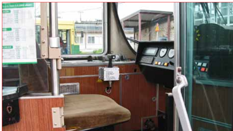
Helsinkiin hankitun Mannheim-vaunun HKL 151 ohjaamo vuonna 2009 asennettuine servokytkimineen. Kuva Arto Hellman 19.5.2009.
