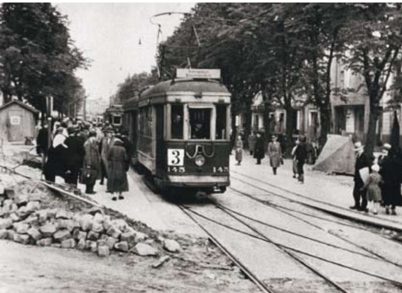
Isoruotsalainen HRO 145 tuttuine aurinkolippoineen ja kaksisuuntaisuudesta kielivine "etupäässä" olevine perävaunun jarruletkuineen Ylioppilastalon keskus pysäkillä Heikinkadulla eli nykyisellä Mannerheimintielle 23.8.1935. Kuva kokoelma Jorma Rauhala.
