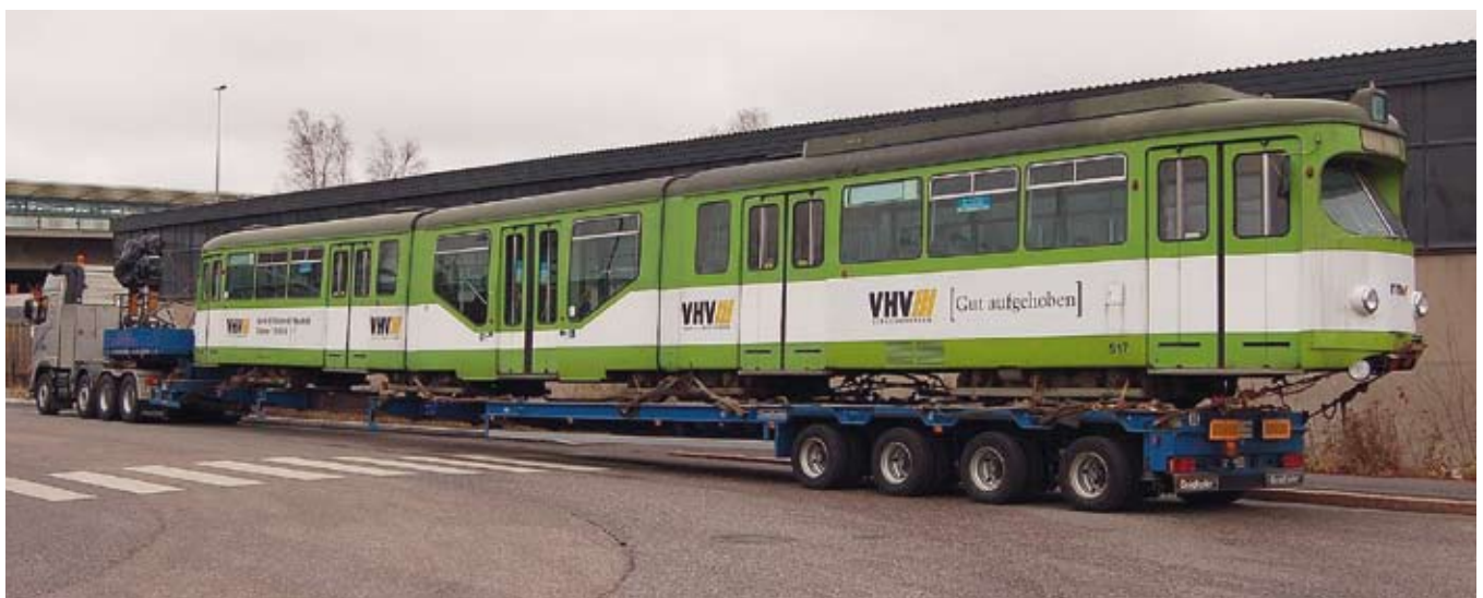
Düwagin valmistama GT8N-osamatalaratikka MVV 517 (tuleva HKL 161) juuri Mannheimista saapuneena. Helsinki, Kalasataman asema, 9.11.2007. Kuva Jorma
