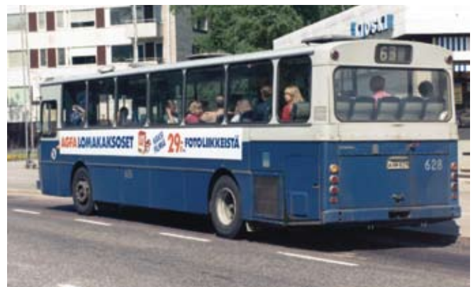
Helsingin kaupungin liikennelaitos 628, Scania BR111M59 / 5900 / Wiima K100-220 vm. 1976. Muista Wiima K100:ista nämä Scaniaat poikkesivat ulkonäkösä puolesta moottoritalan äänieristyskoteloinnin takia. Autoissa 627 - 629 oli alusta pitäen erilaiset linjanumerofontit verrattuna edeltäviin autoihin. Autoissa 625 - 629 kojelauta poikkesi autojen 610 - 624 kojelautoista. Kuva Pertti Leinomäki 25.5.1983, Helsinki.
