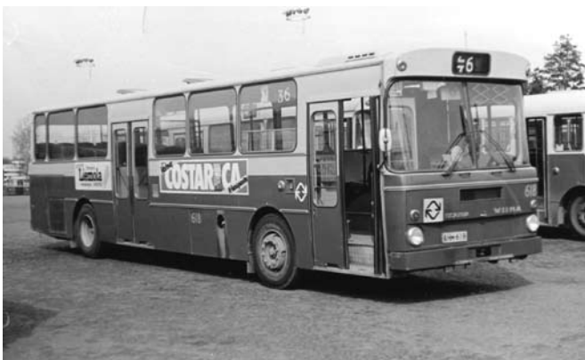
Helsingin kaupungin liikennelaitos 618, Scania BR111M59 / 5900 / Wiima K100-220 vm. 1976. Kuva Helge Kinnunen, Helsinki.
