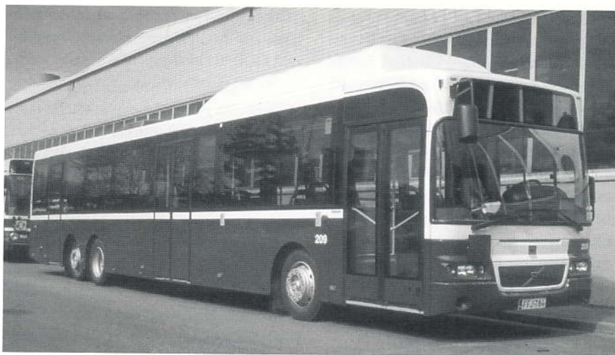
HKL 209, Volvo B10BLE 6x2 CNG / Volvo 8500LE. Korityön teki HKL:n vuoden 2002 maakaasuautosarjaan Volvo-konserniin kuuluva Säfle Karosseri AB. Kuva Juhana Nordlund 26.4.2002.
