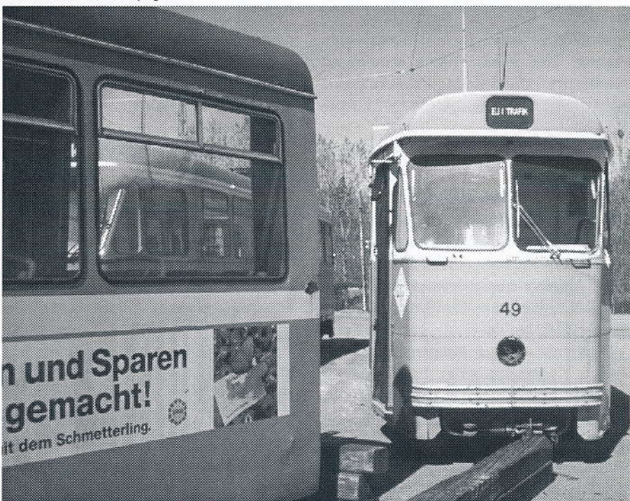
▲ Düwag-vaunun 62 matala keskiosa. Tokihan tämä on lastenvaunujen kanssa liikkuville ja liikuntaesteisille parempi ratkaisu kuin korkealattiavaunu, mutta täysmataliin vaunuihin verrattuna kuitenkin melko yksinkertainen kompromissi. Kuva Juhana Nordlund 8.5.2001, Norrköping
