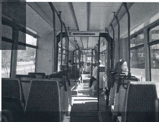
Näkymä täysmatalan M98B 22:n sisätiloista. Vaunu on jonkin verran väljempi kuin helsinkiläinen Variotram. 2,3 m leveään vaunuun 1+2 -penkkijako on mielekkäämpi verrattuna 2+2 -jakoon. Myös otetankoja on sijoitettu riittävästi. Kuva Juhana Nordlund 8.5.2001, Norrköping ▶
