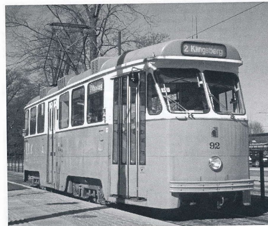
◀ Sarjan M67B vaunu 92 linjalla 2 Matkakeskuksen pysäkillä. Vaunuun tehtiin kevyt saneeraus vuonna 1999. Tätä ennen vaunun tunnus oli M67 ja numero 52. Alunperin vaunun numero oli 152. Etuovet muutettiin kuvan osoittamiksi jo vuoden 1992 täyskorjauksessa, jolloin myös sisustusta muutettiin mm. istuinpäällisten osalta. Vuoden 1999 saneerauksessa muutoksia tehtiin sähköjärjestelmään, linjakilpiin sekä eräisiin muihin laitteisiin. Alkuperäiset ulkovärit kuitenkin säilyivät, samoin virroitintyyppi. Myös yksilyhtinen etuajovalo jätettiin rauhaan. M67B:iden rooli muuttuneen entistä toisarvoisemmaksi, kun loputkin M94:t valmistuvat M97:oina seuraavien kuukausien aikana korjaamolta. Kuva Juhana Nordlund 8.5.2001, Norrköping
