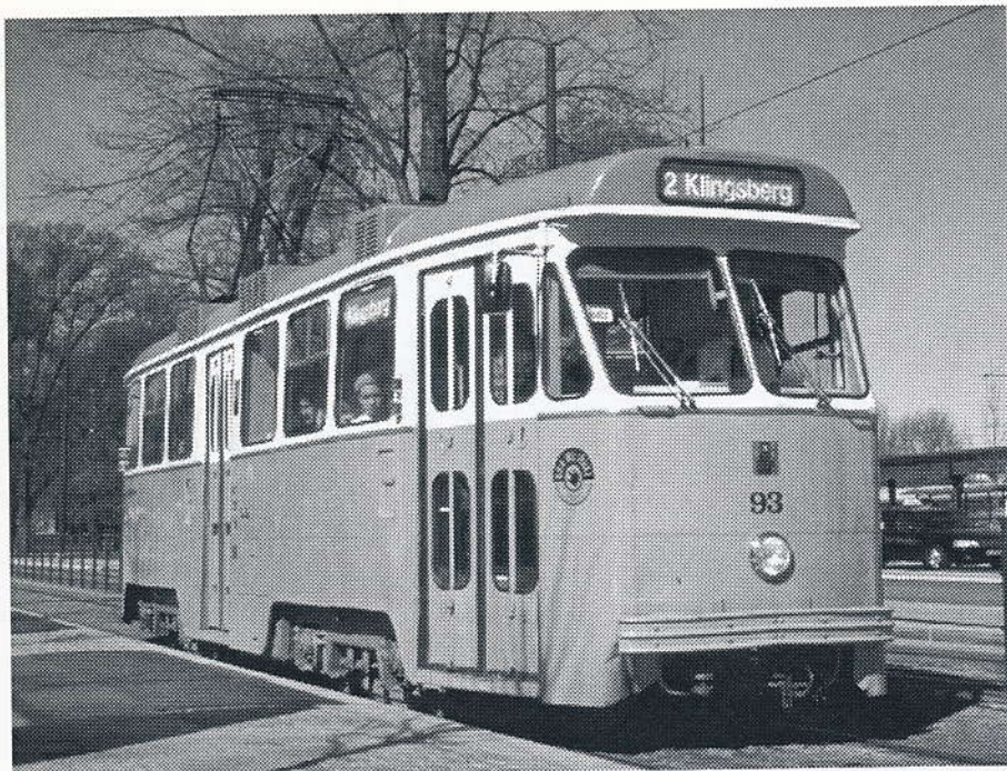
◀ Sarjan M67B vaunu 93 Matkakeskuksen luona. Vaunu on entinen M67 41 (aiemmin 141). Vaunuun on tehty vuonna 1999 kevyt uudistus, jossa muutoksia on tehty mm. sähköjärjestelmään ja linjakilpiin. Ulkoveritys vastaa alkuperäistä, samoin saksisankatyypinen virroitin. Kuva Juhana Nordlund 8.5.2001, Norrköping.
