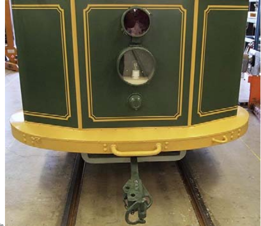
Takana on trumpettikytkinä selviää varmempi Albert-kytkin. Tähän sitten liitetään vaikka SR 233.
