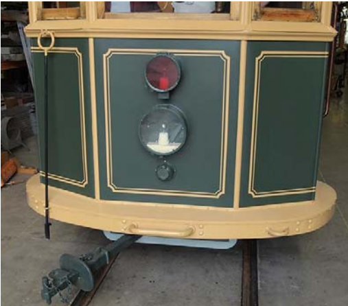
Ehdessä kytkimänä on alkuperäinen trumpettikytkin. Sitä ei ole tarkoitettuakaan käytettäväksi, mutta on se kuitenkin "häätälantessa" käyttökelppoinen: kuvassa näkyvän kytkinraudan avulla alberti ja trumpetti voidaan yhdistää ja näin vaimuu voi hinata. Kytkinrautaa tullaan säilyttämään SR 50:ssä.
