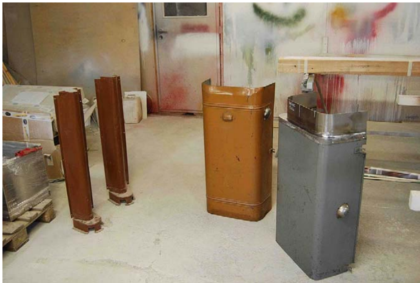
Tummanruskeat putkiot ovat päätyksille tulevia mekaanisen käsijarrun suojia. Vaaleanruskea kotelo on takapäin ajokytkimen suojakotelo. Se maalataan vielä mustaksi. Harmaa kotelo puolestaan on etusillalle tulevan ajokytkimen suojakotelo, ja sekin maalataan mustaksi. ASEA:n (oikeammin AEG:n) alkuperäisiä ajokytkimiä vaunussa ei voida käyttää, mutta takapäin alkuperäinen ajokytkin jää kuitenkin paikoilleen. Vaunu ei siis entisöinnin jälkeen ole ajettavissa molemmista päistä, vaan peruutuskin tehdään etupäästä.
