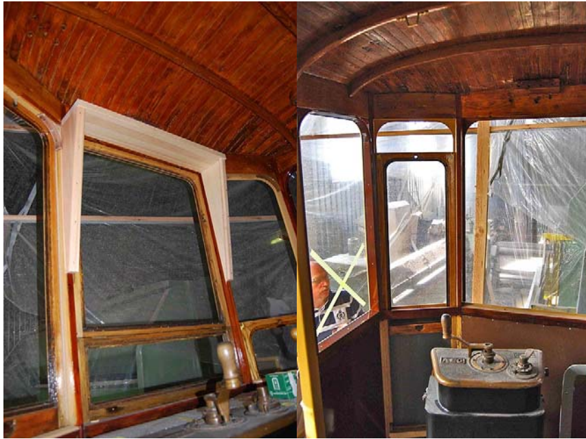
Ohjaamoon palautetaan alkuperäiset ikkunoiden avausmahdollisuudet: tuulilasia voidaan kallistaa sisäänpäin heijastumien välttämiseksi sekä ilmanvaihdon parantamiseksi ja kapeat eteenpäin antavat sivuikkumat voidaan laskea alas. Tätä on käytetty muun muassa vaihdettaessa, mutta nyt vaunuun toki tulee sähkökäyttö. Tuulilasin kallistuksen mahdollistavat raamit ovat kuvassa vielä luonnosvaiheessa, lopputuloksesta ei tule aivan näin massiivisenoloinen. Kuvat 27.9. ja 25.8.2011.
