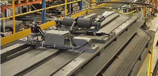
Lylyavirrotin. Alun perin laahain oli alumiinia. Mutta nykyvaatimusten vuoksi laahainosassa on hiililaahain.
