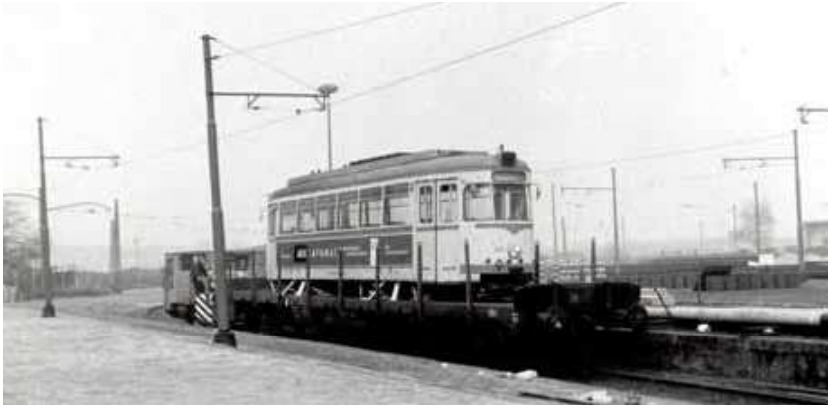
Vestischen Helsinki-vaunu 341 lähössä vuonna 1974 kohti uutta kolmatta käyttömaatansa, eli Suomen ja Saksan jälkeen on nyt suuntana Itävalta. Vaunu on kuormattuna tavaravaunun päälle telit ja virroitin poisotettuina, jotta erikoiskuljetus mahtuu sujuvasti rautateiden kuormauttuman sisään. Aseman pieni vaihtoveturi on jo kytkeytynyt lähtevään vaunuun. Kuva Vestische Straßenbahnen GmbH:n arkisto via Norbert Konegen.
