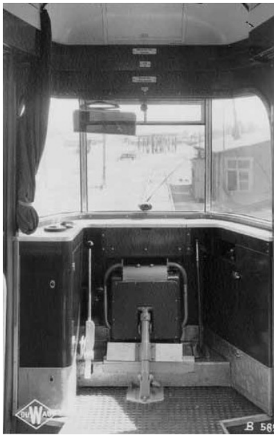
Vestischen Großraum-vaunusarjan 340–351 B-pään ohjaamo. Vasemmalla kuljettajan tuoli on käyttöasennossa, oikealla puolestaan suljetun ajopöydän alle taitettuna. Kaikki tämän sivun kuvat ovat vaunusta 350 Recklinghausenin varikolla vuonna 1952. Kuvat Düwag-Bildarchiv via Wolfgang-Dieter Richter.
