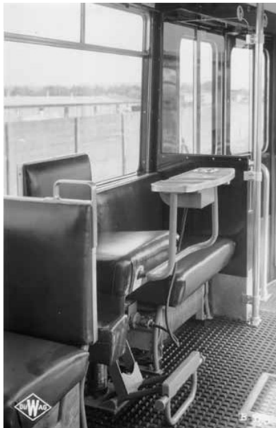
Vestischen Großraum-vaunusarjan 340–351 rahastajanaitio, joka oikeanpuoleisessa kuvassa on muutettu kaksisuuntavaunun ajopöydässä matkustajapaikoiksi.
