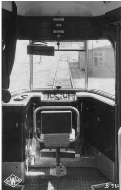
Vestischen Großraum-vaunusarjan 340–351 B-pään ohjaamo. Vasemmalla kuljettajan tuoli on käyttöasennossa, oikealla puolestaan suljetun ajopöydän alle taitettuna. Kaikki tämän sivun kuvat ovat vaunusta 350 Recklinghausenin varikolla vuonna 1952. Kuvat Düwag-Bildarchiv via Wolfgang-Dieter Richter.
