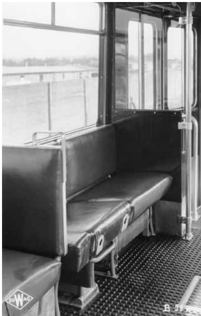
Vestischen Großraum-vaunusarjan 340–351 rahastajanaitio, joka oikeanpuoleisessa kuvassa on muutettu kaksisuuntavaunun ajopöydässä matkustajapaikoiksi.
