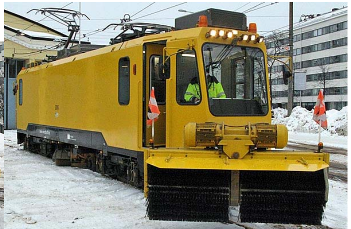
Lumihaarjan ääriasentoja./ Extreme positions of the snow brush.
