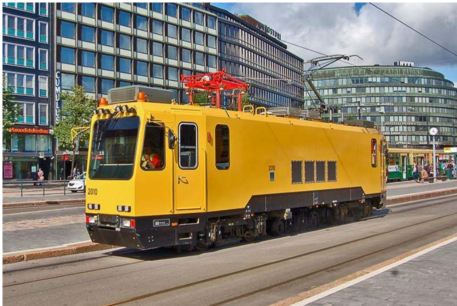
HKL 2010 vuonna 2014, Uusi huurteenpoistovirroittin
