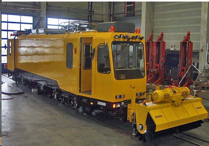
Vaunu tehtaalla talvivarustuksessa / The car at Windhoff with winter equipment. Kuvat / Pictures © Erkki Mutka Lumiharjan valmistaja on / Snow brush: Zaugg AG Eggiwil
