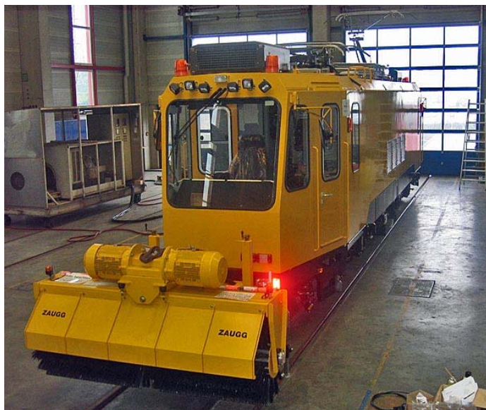
Vaunu tehtaalla talvivarustuksessa / The car at Windhoff with winter equipment. Kuvat / Pictures © Erkki Mutka Lumiharjan valmistaja on / Snow brush: Zaugg AG Eggiwil
