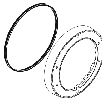
Compensatierozet 22 mm (bij geringe inbouwdiepte)
