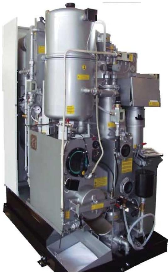
modello studiato per le piccole utenze e la lavanderia tradizionale, per il massimo risparmio energetico, idrico e di solvente, duttilità di utilizzo, distillazione continua per la perfetta qualità di lavaggio.
